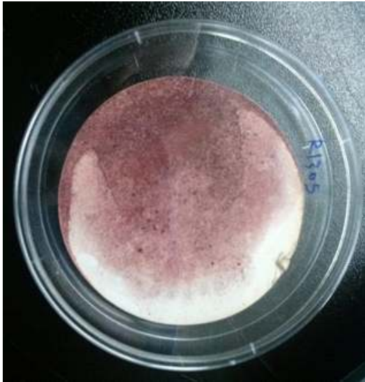
[그림 15] \text{CuCl}_2 를 넣지 않고 합성했을 때의 결과
